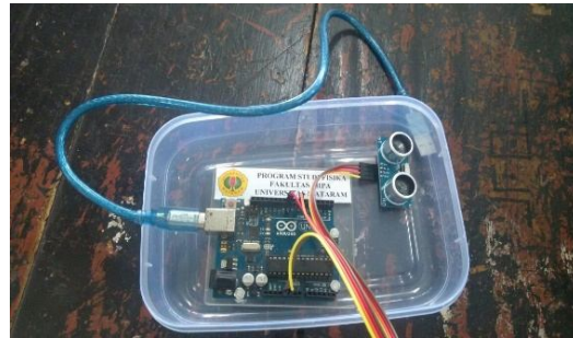
Gambar 5. Modul Arduino Uno, Sensor suhu LM35 dan sensor jarak BMP05
