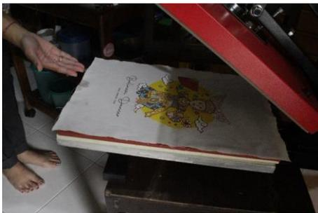
Gambar 8. Hasil Cetakan Mesin *Heat Press*
