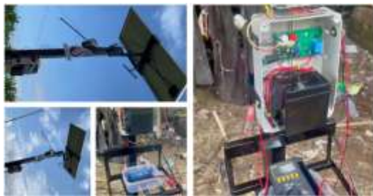
Gambar 2. Dokumentasi Alat IoT Pengusir Hama Burung
